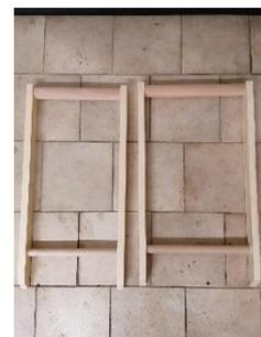
9. Runde mit der Raspel die Ecken so ab, dass sie an das Rundholz angeglichen sind.
